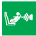
SISTEMA DI RILEVAMENTO PRESENZA DEL SISTEMA DI RITENUTA PER BAMBINI E SUO ORIENTAMENTO (CPOD) E014 ●
